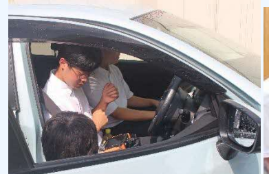
▲自動車整備士：外部診断機で故障箇所を確認
